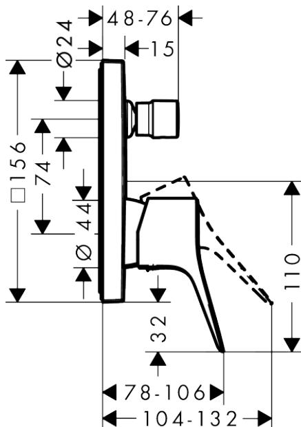
**Vivenis****Einhebel-Wannenmischer Unterputz mit integrierter Sicherungskombination nach EN1717 für
