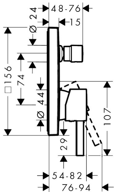
**Finoris****Einhebel-Wannenmischer Unterputz mit integrierter Sicherungskombination nach EN1717 für
