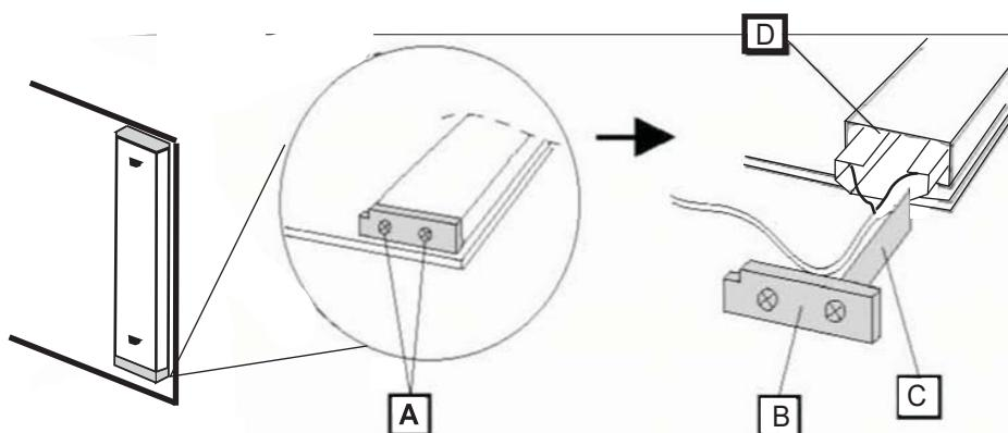
Lösen Sie die Schrauben (A) und nehmen Sie die Plastikkappe (B) und die Metallfolie (C) ab, falls vorhanden.
