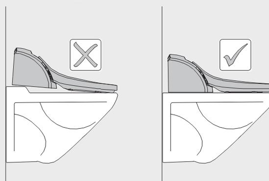
Die Keramik muss eine Form haben, auf der alle Gummipuffer und das Gehäuse immer auf der Keramik aufliegen, also z. B. nicht zu schmal, zu rund oder zu eckig
