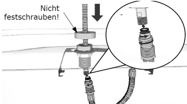
3. Brauseschlauch einführen und mit Panzerschlauch verbinden.
