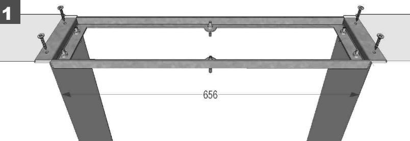
Montagerahmen auf Mauerwerk einhängen, ausrichten und befestigen.
