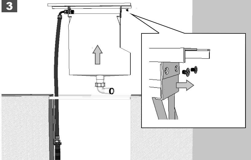
3. Trägerplatte mit Schlauchkasten aus Rahmen herausheben und die Verschraubung des Schlauchkastens lösen.
