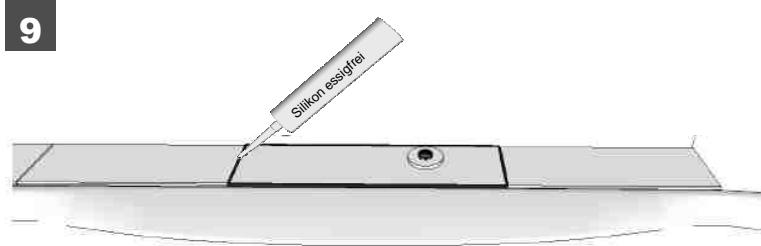
9. Einsetzen der gefliesten Trägerplatte und ausfüllen der Fuge mittels essigsäurefreiem Silikon.
