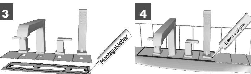
Fliesen bohren, ggf. zuschneiden und auf der Armaturenträgerplatte mit einem aushärtenden Kleber anbringen (3). Anschließend erfolgt die Montage der Armatur gemäß entsprechender Montageanleitung. Einsetzen der gefliesten Trägerplatte in Montagerahmen und ausfüllen der Fuge mittels essigsäurefreiem Silikon (4).
