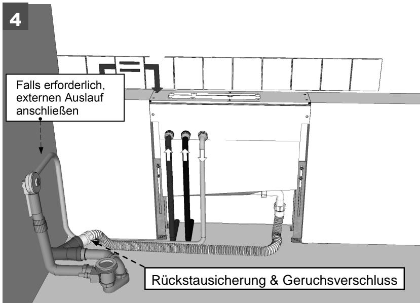
Kalt- und Warmwasseranschluss herstellen. Falls erforderlich, externen Auslauf anschließen (wenn nicht auf Trägerplatte montiert). Ablaufschlauch am Schlauchkasten und an Abflussleitung anschließen.
