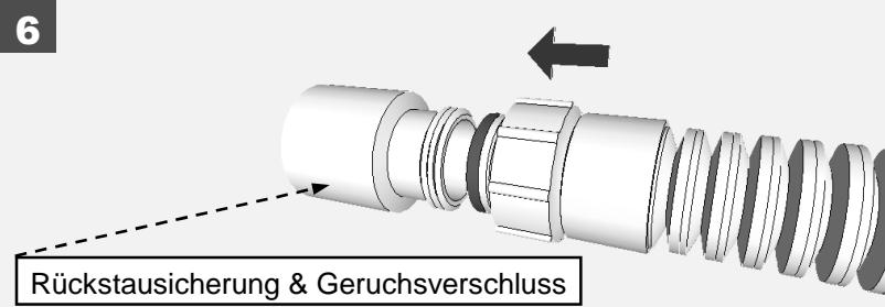
6. Ablaufschlauch an Abwassersystem anschließen.
