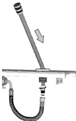
5. Brauseschlauch einführen und mit Panzerschlauch verbinden.
