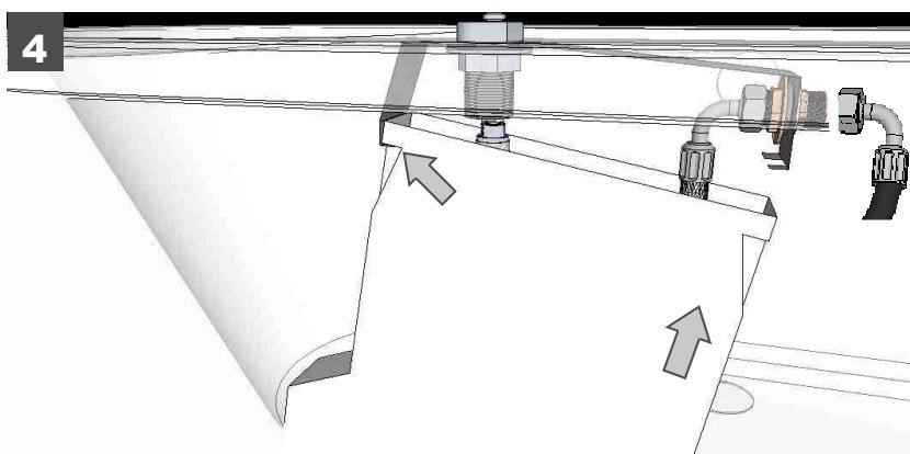
4. Schlauchkasten einsetzen und Wasseranschluss herstellen.
