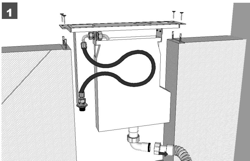
1. Montagerahmen auf Mauerwerk einhängen, ausrichten und befestigen.
