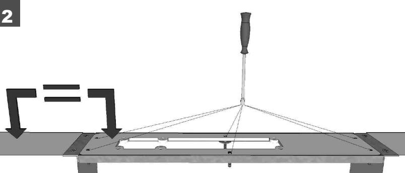
Armaturengrägerplatte in den Montagerahmen einlegen. Die Höhe und die Höhengleichheit kann mittels der 6 Stellschrauben justiert werden.
