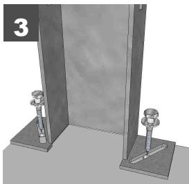
Montagegestell entfernen und an angezeichneten Stellen Bohren (2). Gestell platzieren und mit Dübeln und Schrauben befestigen (3). Muttern lösen, Montagerahmen auf die Höhe des Mauerwerks hinab gleiten lassen und fixieren.
