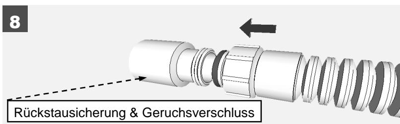
8. Ablaufschlauch an Abwassersystem anschließen.
