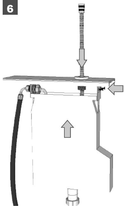
6. Schlauchkasten einsetzen, verschrauben und Brauseschlauch einschieben.
