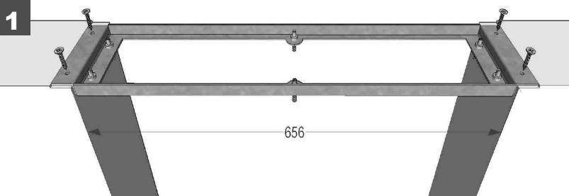
Montagerahmen auf Mauerwerk einhängen, ausrichten und befestigen.
