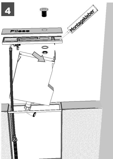
4. Schlauchkasten entfernen.
