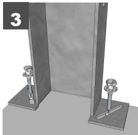
Montagegestell entfernen und an angezeichneten Stellen Bohren (2). Gestell platzieren und mit Dübeln und Schrauben befestigen (3). Muttern lösen, Montagerahmen auf die Höhe des Mauerwerks hinab gleiten lassen und fixieren.
