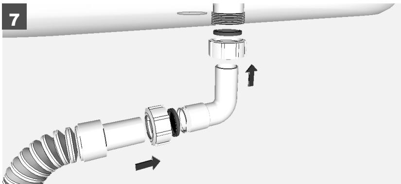
7. Ablaufanschluss an Schlauchkasten anschließen. Auf korrekten Sitz der Dichtungen achten.
