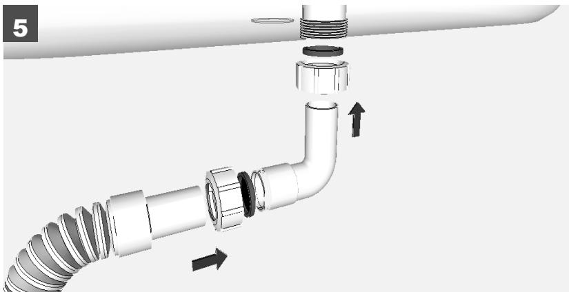
5. Ablaufanschluss an Schlauchkasten anschließen. Auf korrekten Sitz der Dichtungen achten.
