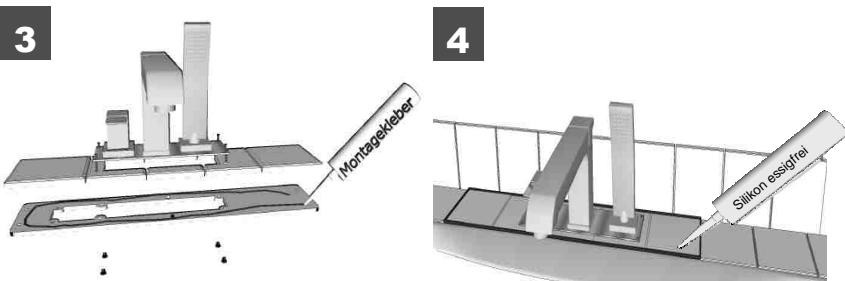
Fliesen bohren, ggf. zuschneiden und auf der Armaturengrägerplatte mit einem aushärtenden Kleber anbringen (3). Anschließend erfolgt die Montage der Armatur gemäß entsprechender Montageanleitung.
