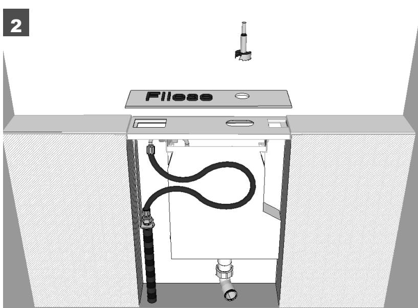
2. Fliesen bohren und ggf. zuschneiden. Wasseranschluss herstellen.
