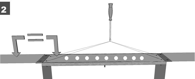
Armaturenträgerplatte in den Montagerahmen einlegen. Die Höhe und die Höhengleichheit kann mittels der 6 Stellschrauben justiert werden.
