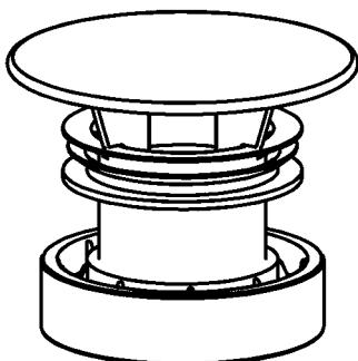
3. Hilfsmutter (5) entfernen und durch verchromte Befestigungsmutter (4) ersetzen. Schaftventil im Ablauf ausrichten und durch Anziehen der Befestigungsmutter fixieren.
