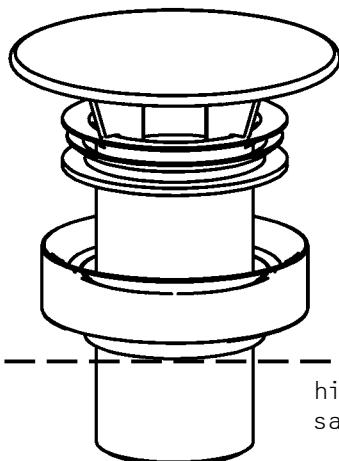
1. Stülpdichtung (3) im Ablaufloch des Beckens einsetzen. Schaftventil (2) von oben durch das Ablaufloch führen.
