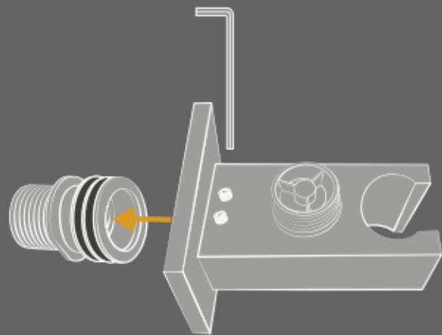
Öffnen Sie die zwei Madenschrauben um den Gewindenippel aus dem Wandanschlussbogen / Kombihalter lösen zu können. Bei Bedarf längen Sie den Gewindenippel einfach ab.
