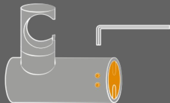
Öffnen Sie die Madenschraube um die Wandbefestigung aus dem Halter zu lösen.
