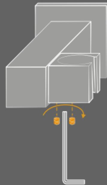
Stecken Sie den Wandanschlussbogen / Kombihalter fest auf den Wasserauslass und fixieren diesen wieder mit den zwei Madenschrauben auf der Unterseite.
