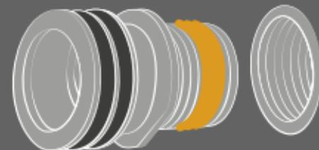
Montieren Sie den Gewindenippel in den Wandanschluss.
