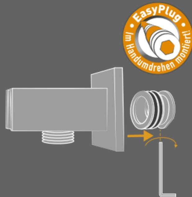
Stecken Sie den Wandanschlussbogen / Kombihalter fest auf den Wasserauslass und fixieren diesen wieder mit den zwei Madenschrauben auf der Unterseite.
