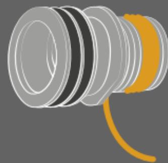
Verwenden Sie zur Abdichtung nur zugelassene Dichtmittel.
