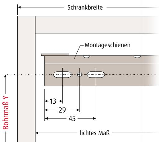
Das Höhenmaß für die Montageschienen „das sogenannte **Bohrmaß**“ errechnet sich aus dem angegebenen Montagemaß für Wandhaken abzüglich 10 mm, zum Beispiel:
