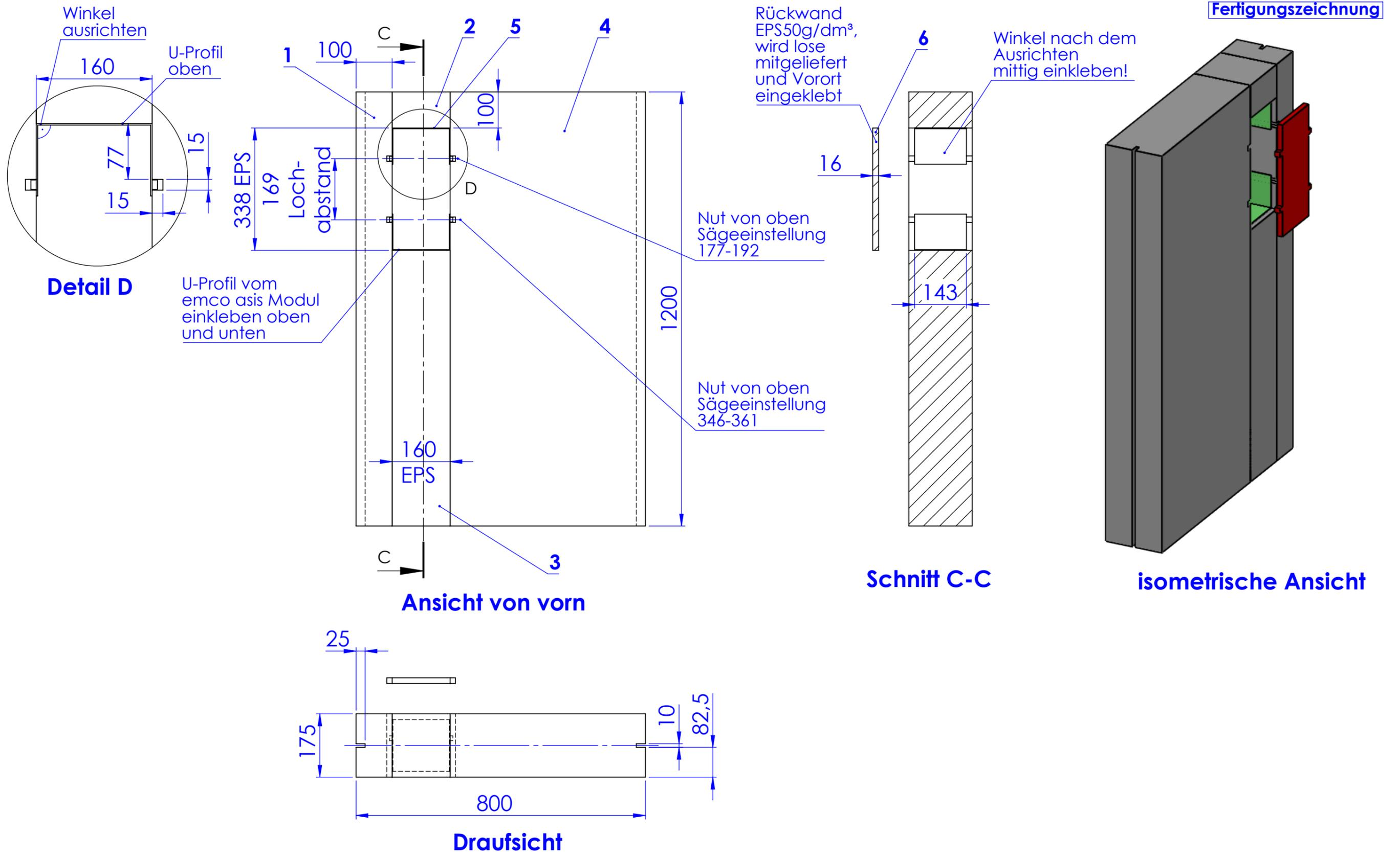
**Nuten für Befestigung der Systemschiene, nur vorn und hinten einfräsen, unten weglassen!
