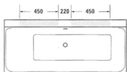
Im Bereich der grauen Fläche sind Armaturenbohrungen möglich.
