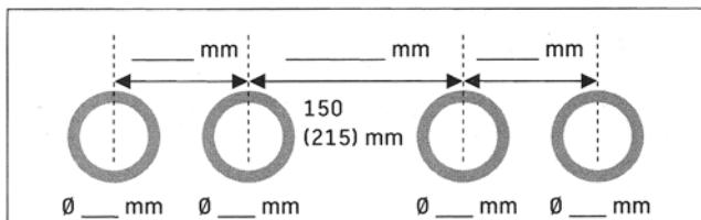
Bitte beachten Sie bei DuraStyle den Mindestabstand zwischen den 2 mittleren Bohrungen. Der Mindestabstand bei Einsatz einer Ab- und Überlaufgarnitur ohne Wanneneinlauf beträgt 150 mm, bei einer Ab- und Überlaufgarnitur mit Wanneneinlauf 215 mm.
