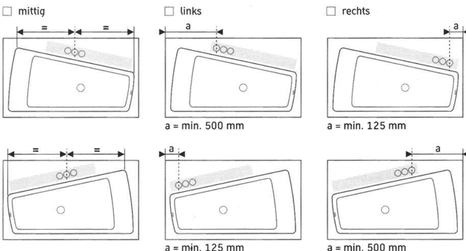
**3. Schritt: Wenn die Armatur mittig positioniert werden soll, geben Sie bitte an, wo die Mittelachse der Wanne in Bezug auf die Bohrungen verlaufen soll.**
