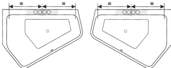
**3. Schritt: Wenn die Armatur mittig positioniert werden soll, geben Sie bitte an, wo die Mittelachse der Wanne in Bezug auf die Bohrungen verlaufen soll.**
