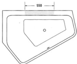
Im Bereich der grauen Fläche sind Armaturenbohrungen möglich.
