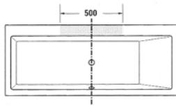
**2. Schritt:** Bitte kreuzen Sie die Positionierung der Bohrungen auf dem Wannenrand an.
