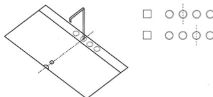
**4. Schritt: Bohrbild vermaßen. Bitte tragen Sie den Bohrabstand und Bohrdurchmesser für jede Bohrung direkt in die Zeichnung ein.**
