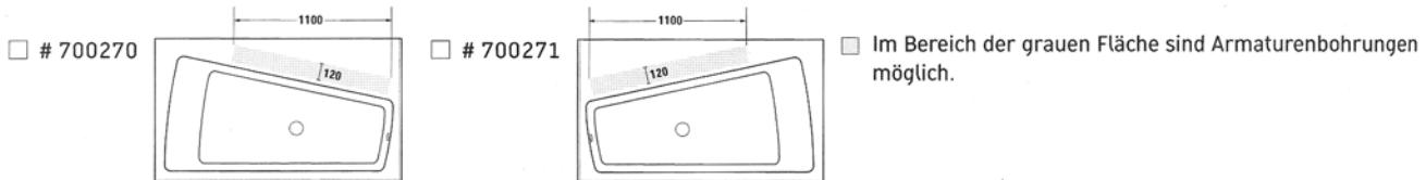
**2. Schritt: Bitte kreuzen Sie die Positionierung der Bohrungen auf dem Wannenrand an.**
